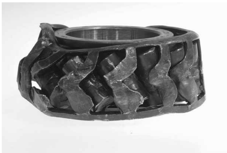
Rys. 1: Wydzielanie nadmiernej ilości ciepła spowodowało całkowite zatarcie łożyska.
