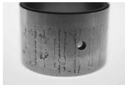
Rys. 3: Wżery od korozji powstałe na powierzchni pierścienia wewnętrznego łożyska walcowego.
