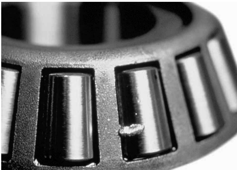
Rys. 2: Duże cząstki zanieczyszczeń zatrzymane w koszu łożyska
