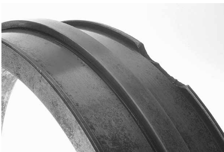
Rys. 6: Pęknięcie obrzeża pierścienia wewnętrznego łożyska baryłkowego spowodowane użyciem nieprawidłowych narzędzi podczas montażu.
