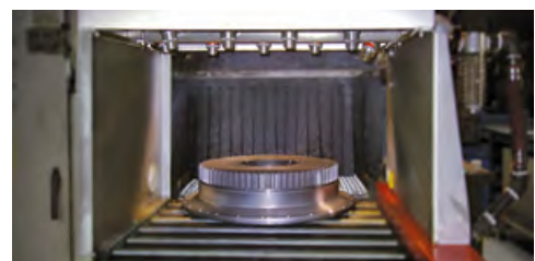
Seria regulowanych wzmacniaczy przepływu powietrza suszy i chłodzi duży odlew, po procesie mycia w wysokiej temperaturze.
