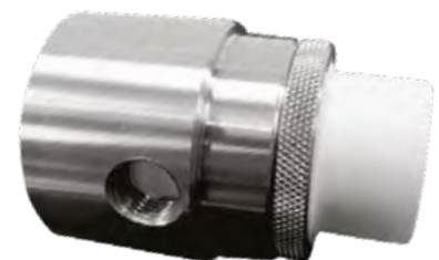
Strumień powietrza z tego regulowanego wzmacniacza przepływu powietrza ze stali nierdzewnej z wkładką teflonową pomógł zassać kleisty materiał z procesu i zapobiegł jego osadzaniu na wzmacniaczu.
