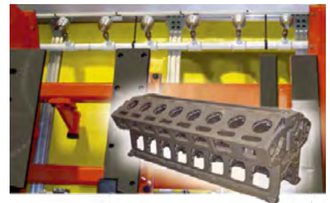
Szereg regulowanych wzmacniaczy przepływu powietrza model 6042 2" (51 mm) zdmuchuje chłodziwo z 16-cylindrowego silnika wysokoprężnego.
