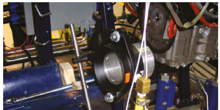
Wzmacniacz przepływu powietrza „Super” model 120024 4" (102 mm) chłodzi silnik podczas badania przy pomocy dynamometru.
