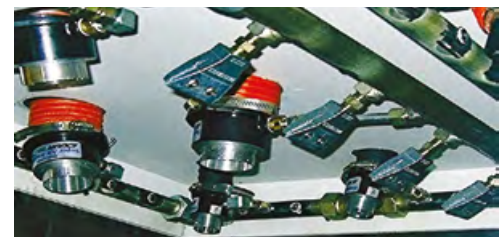
Wzmacniacze przepływu „Super” model 120022 oraz płaskie dysze powietrzne odmuchują przekładnie po obróbce.
