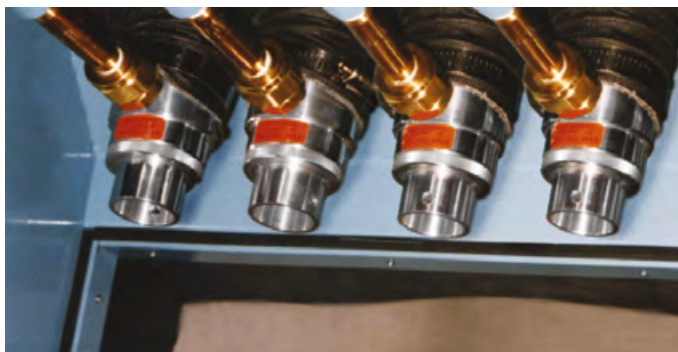
Regulowane wzmacniacze przepływu powietrza są podłączone do przewodów w celu zasysania czystego powietrza do suszenia.
