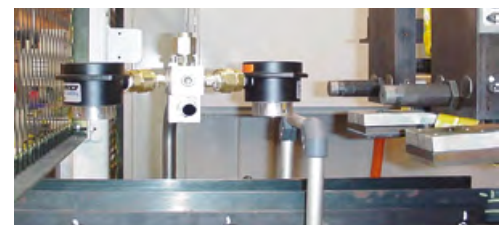
2 szt. wzmacniaczy przepływu powietrza „Super” model 120022 suszą części, podczas gdy przesuwają się one po przenośniku taśmowym.
