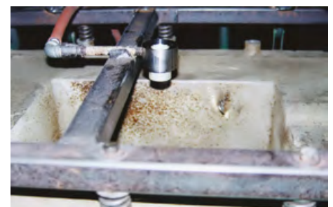
Wzmacniacz przepływu powietrza do wysokich temperatur model 121021 kieruje gorące powietrze na obrotowe gniazdo formy dla zapewnienia jednolitej grubości ścianki wypraski.
